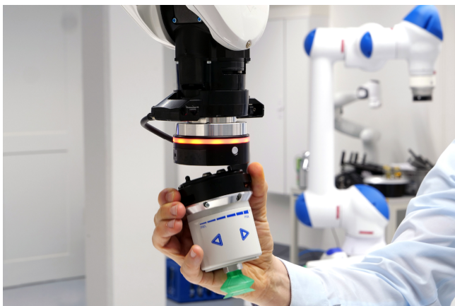
Schnellwechselmodul RMQC beim manuellen Greiferwechsel
